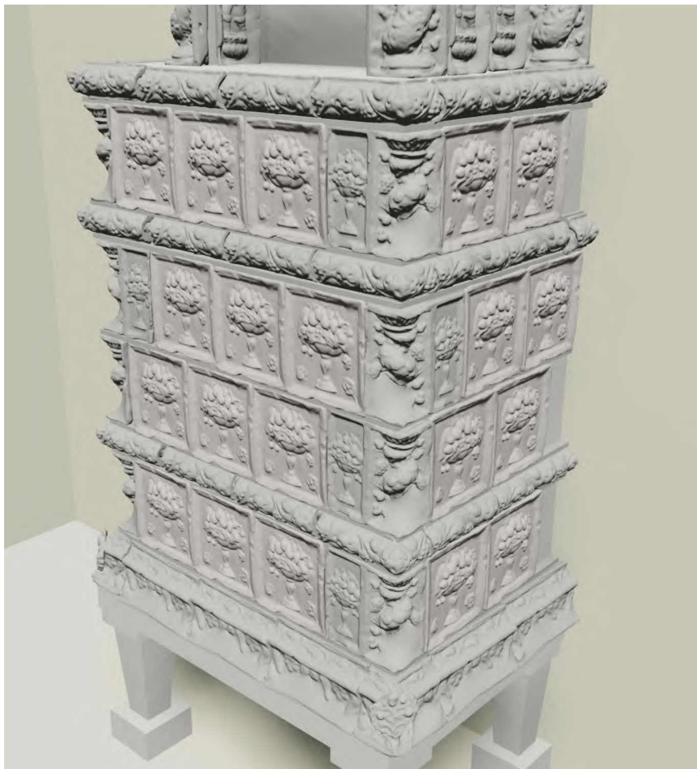
Abb. 24 HL 300, Breite Straße 25, Rekonstruktion des Ofenunterbaus.
