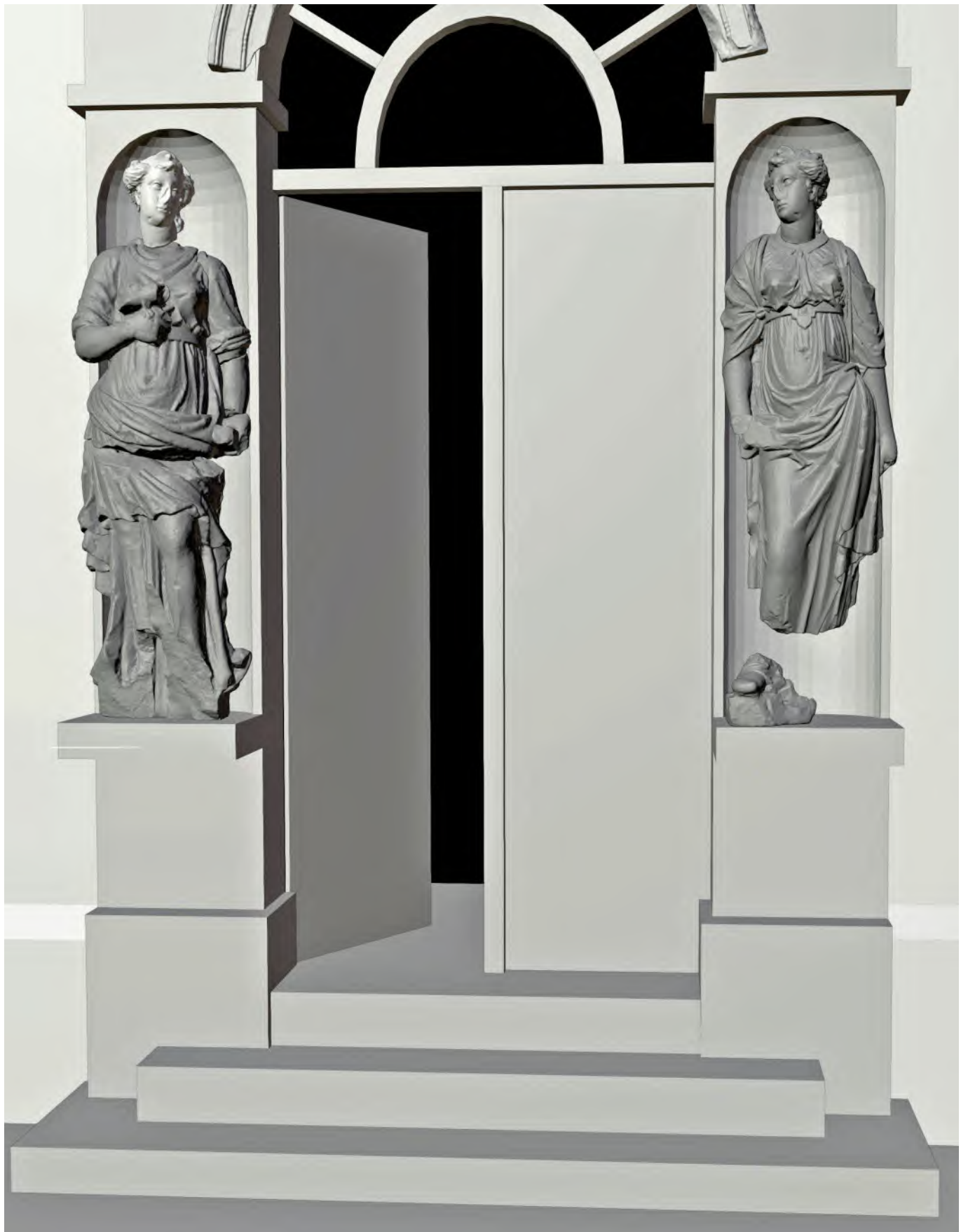
Abb. 25 Breite Straße 27, Rekonstruktion des Sandsteinportals, unterer Bereich.
