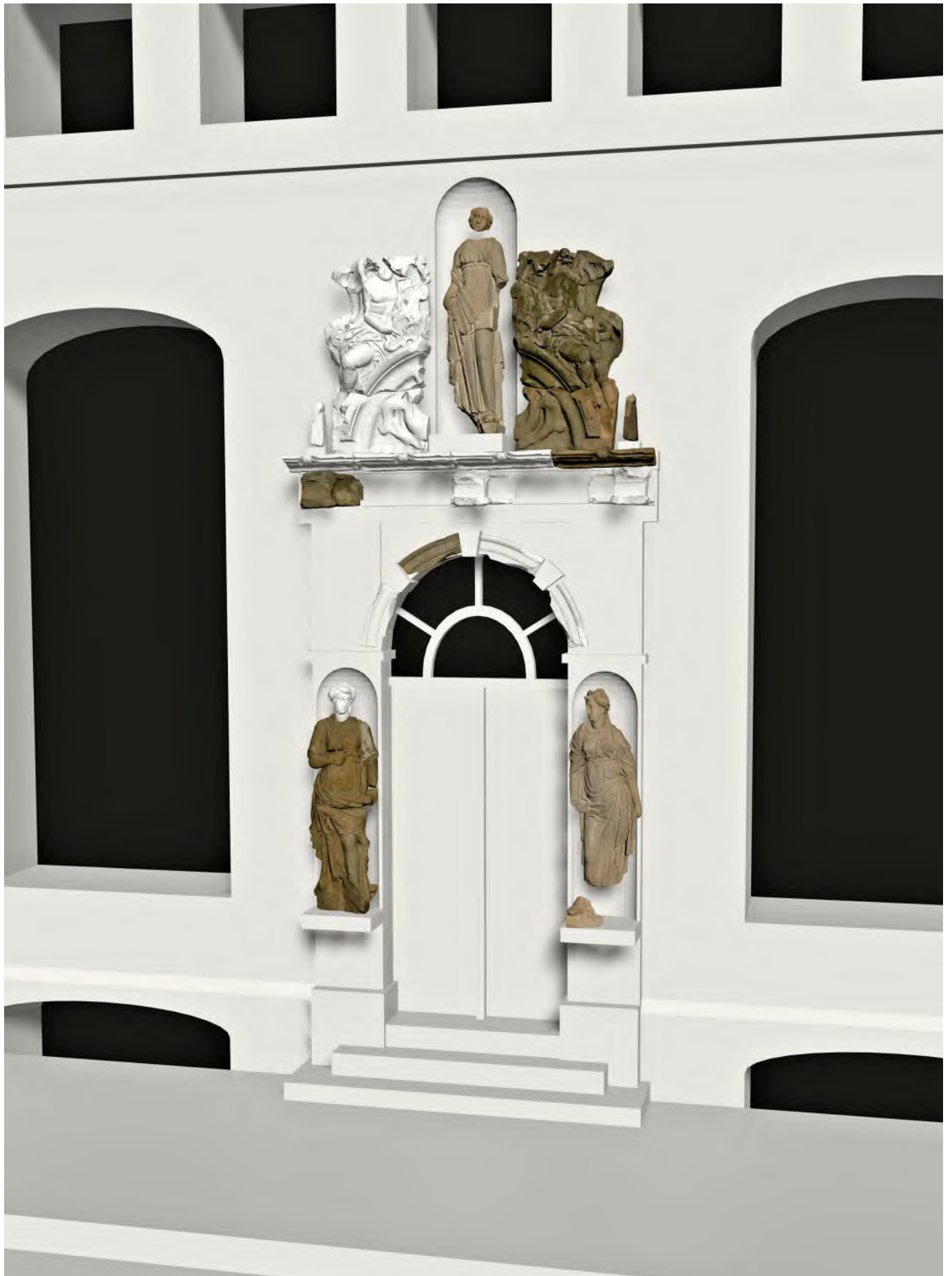
Abb. 27 Breite Straße 27, Rekonstruktion des Sandsteinportals, Gesamtansicht (ergänzte Teile hellgrau dargestellt).
